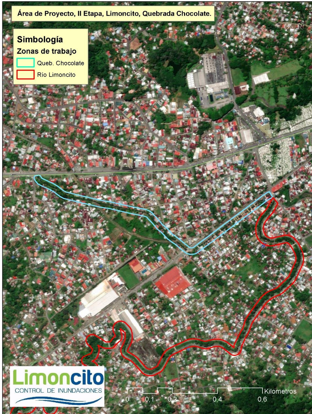
Imagen 2. Área de trabajo, La línea celeste sería la zona de recava del cauce de la quebrada Chocolate, para la 2da etapa y también sería la zona de tala de árboles.
